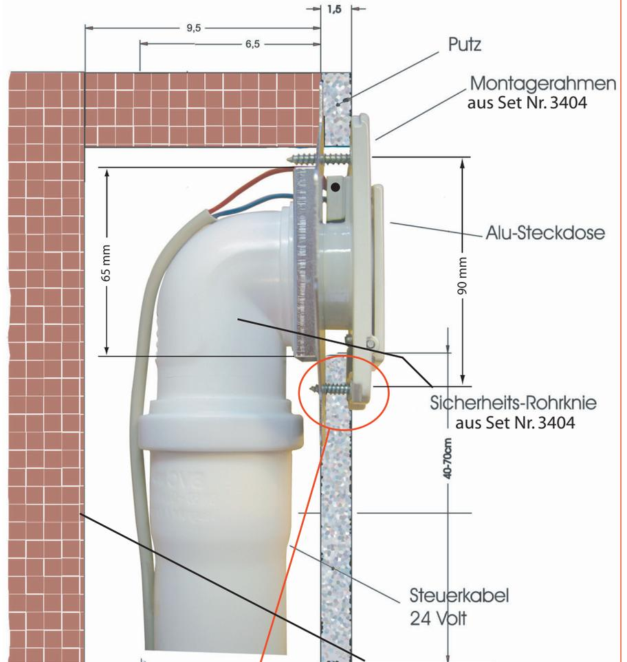
Achtung zur Befestigung der unteren Schraube ist die Wahl der richtigen Schraubenlänge sehr wichtig, da sonst bei Verwendung der falschen Schraubenlänge das Saugrohr angebohrt wird.
